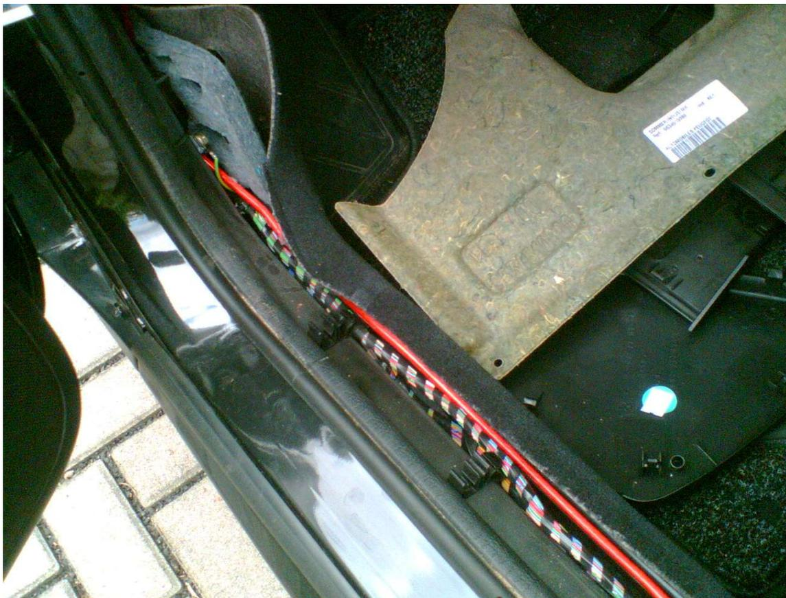
Beim 3-Türer kann man dann das Kabel ganz easy hinter der Plastikverkleidung entlang legen, wenn die Rückbank nach vorne geklappt ist:
