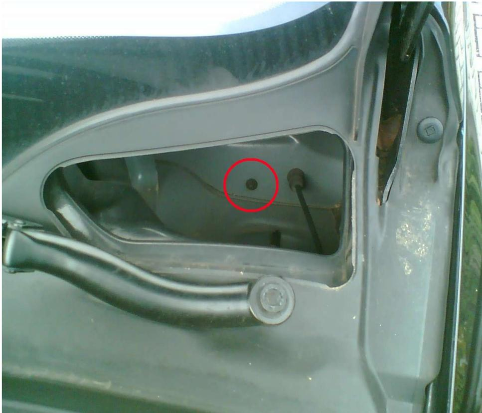
Von diesem Gummistopfen habe ich mit einer Kneifzange die Spitze abgeknipst, und habe da dann mein Kabel (10mm<sup>2</sup>) durchgezogen. Bei grösseren Kabeln sollte man ggf den Blindstopfen komplett entfernen, danach aber das Abdichten mit Silikon nicht vergessen!
