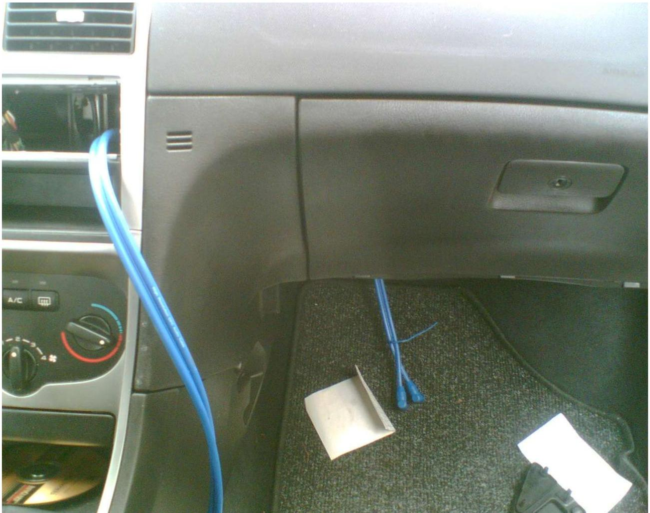
Einfach dann den Teppich unterm Handschuhfach lösen, Kabel dadrunter verstecken und dann wie auf der Fahrerseite die Stromkabel verlegen:
