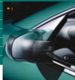
● 3 Elektrisch beheizbare, verstellbare und einklappbare Rückspiegel.
