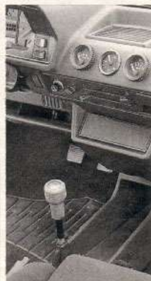
VW Polo G 40 Drei Rundinstrumente (Ladedruck-, Öldruck- und Öltemperaturanzeige) dienen der Kontrolle des Motors
